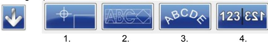
1. Erstellt in CorelDraw automatisch Passmarken an den Ecken des Plots. Dies ist wichtig für Mehrfarbige Plots oder das Konturschneiden von gedruckter Folie. Näheres dazu wird in einem eigenem Abschnitt dieser Anleitung beschrieben. Konturschneiden mit Passmarken.
