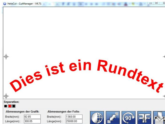
Im Cutmanager können Sie jetzt z.B. den Hintergrund weg klicken und nur den Rundtest und die Markierungen plotten. Danach Plotten Sie den Schatten und die Markierungen. Nach dem entgittern können Sie sich jetzt beim Zusammensetzen des Plots an den Markierungen orientieren.
