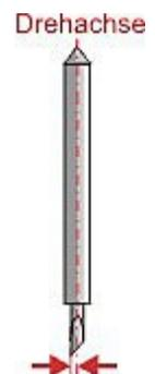
Dieser Abstand muss der Schneidesoftware HeloCut5 bekannt gemacht werden, damit sie ihn bei der Berechnung der Schnittpfade berücksichtigen und kompensieren kann.
